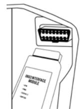
Stecken Sie dann das OBD-II-Modul in den OBD-II-Anschluss des Fahrzeugs und schalten Sie die Zündung ein.
