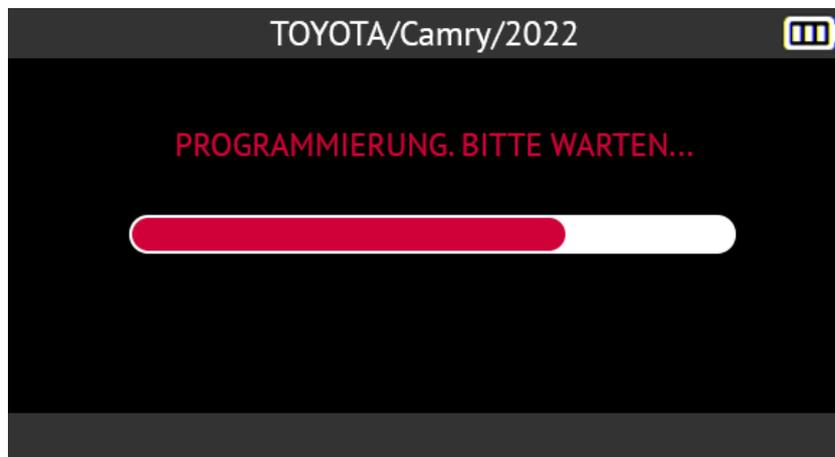
Wenn die Programmierung abgeschlossen ist, wird der neue Sensor erstellt. Der Gerätbildschirm zeigt die Informationen zum Sensor und die Meldung **Erfolgreich programmiert an**.
