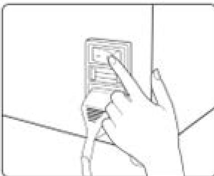
Odłączyć przewód zasilający.
