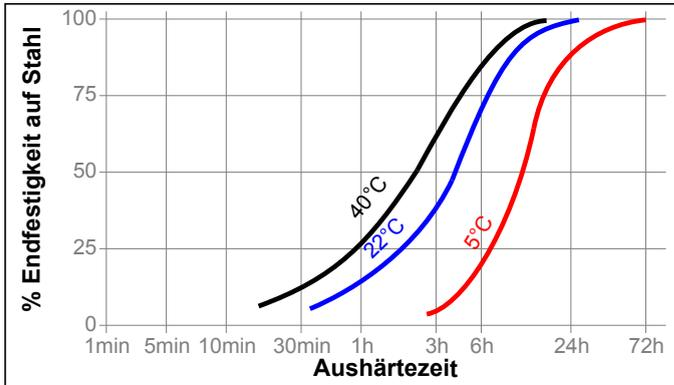
**Aushärtegeschwindigkeit in Abhängigkeit vom Aktivator**
