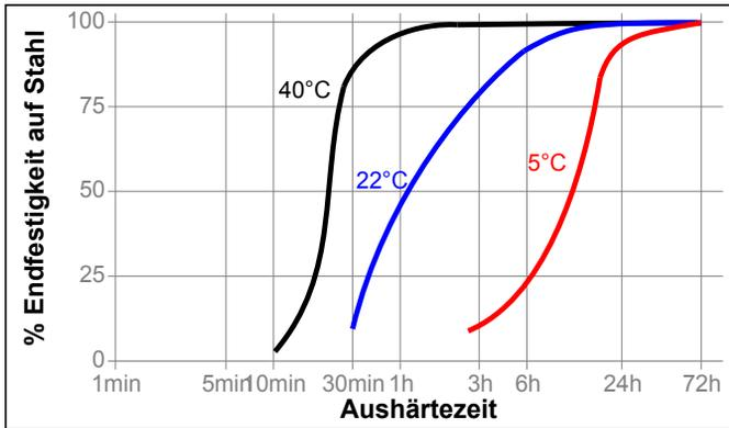
**Aushärtegeschwindigkeit in Abhängigkeit vom Aktivator**
