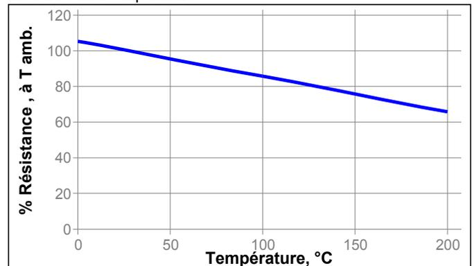
**Résistance au vieillissement à chaud :** Vieillissement à la température indiquée et mesure après retour à 22 °C
